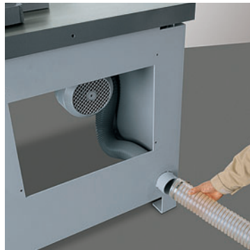
Tuyau d'aspiration sur le bâti de la machine. (Tuyau d'aspiration: Ø 100 mm)
