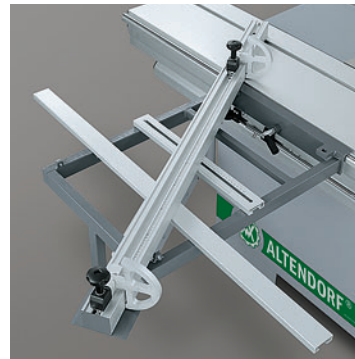
Guide d'onglet transversal : pour une coupe précise d'équerres et d'onglets en une fonction. Plage de tronçonnage : 105–2600 mm. Réglage progressif de l'angle d'inclinaison jusqu'à 49°.
